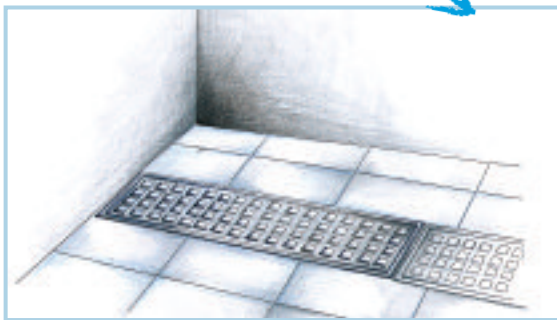
copertura di cavi cable covering
