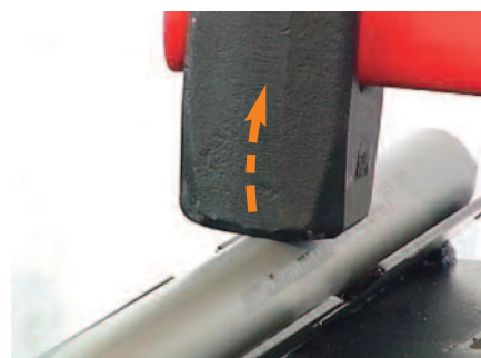
2 Dopo l'urto il tubo ULTRAMAX by REDI torna alla sua forma originale senza rotture o schiacciamenti
