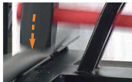
1 Prova di schiacciamento di un tubo ULTRAMAX by REDI. Durante la prova il tubo viene colpito da un martello di 5 kg
